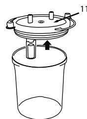
1. Desmonte el dispositivo de protección (10) del tapón de cierre del vaso (11).
